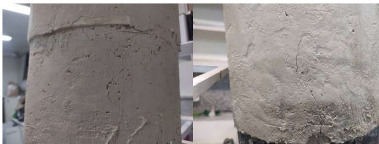
شکل ۴ ایجاد ترک‌های جزئی در مرحله اول در قسمت میانی با لایه بتونی به ضخامت ۸ میلی‌متر با شدت پالس ۵۰۰ ژول و با تعداد ۱۰ پالس.
