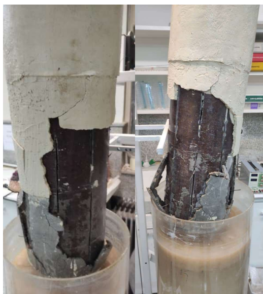
شکل ۵ فروریختن در مرحله دوم در قسمت میانی در لایه بتونی به ضخامت ۸ میلی‌متر با انرژی پالس ۱۰۰۰ ژول و با تکرار ۲۰ پالس.
