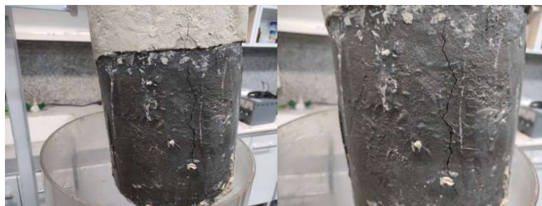
شکل ۳ ایجاد ترک‌های جزئی در مرحله اول در قسمت پایینی با لایه بتونی با ضخامت ۴ میلی‌متر با شدت پالس ۲۰۰ ژول و با تعداد ۵ پالس.
