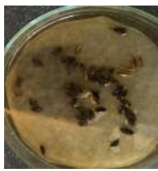
(ب) نمونه (۲) تیمار شده با پلاسما در ولتاژ 7kv و مدت زمان 6min.
