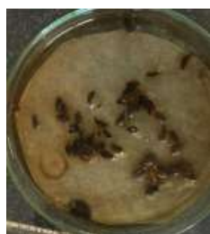
(خ) نمونه (۳) تیمار شده با پلاسما در ولتاژ 14kv و مدت زمان 9min.
