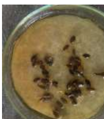
(ب) نمونه (۲) تیمار شده با پلاسما در ولتاژ 14kV و مدت زمان 3min
