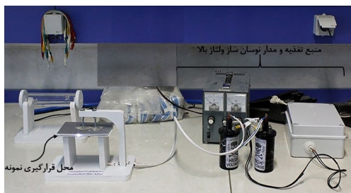
شکل ۱ دستگاه مولد پلاسماي سرد (تخلیه سد دی‌الکتريک) واقع در آزمایشگاه فیزیک.
