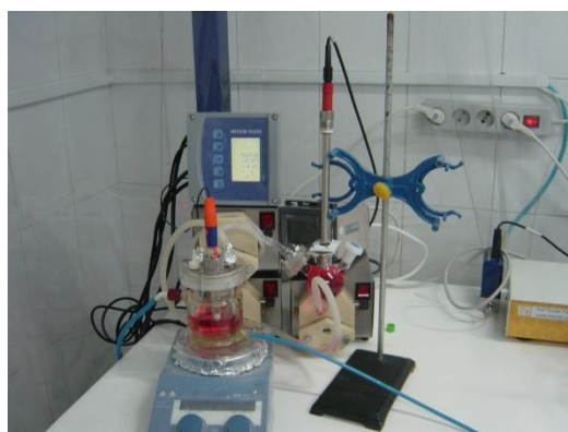
شکل ۲: بیوراکتور پرفیوژن با لوپ همزن خارجی راه اندازی شده در آزمایشگاه
