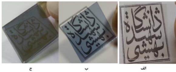
شکل ۵. تصویر قطعات ساخته شده الف) \text{Ca}(20\text{nm})/\text{Ag}(10\text{nm})/\text{ZnS}(25\text{nm})
