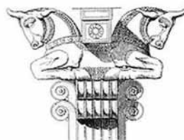
تصویر (۱۵): طرح سرستون تخت جمشید و قرارگیری تیرهای حامل سقف، طراحی بوسیله اوژن فلاندن.
